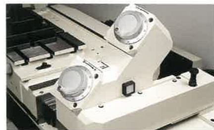
使いやすいスライド式ワークテーブル用手パンドル（標準） Easy-to-operate manual pulse handle (standard) for slide worktable.
